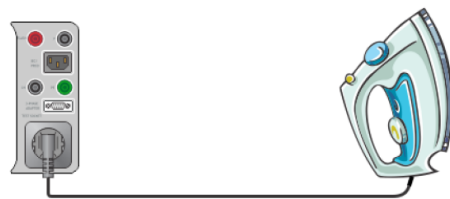
Test izolačného odporu pre spotrebič triedy I.
