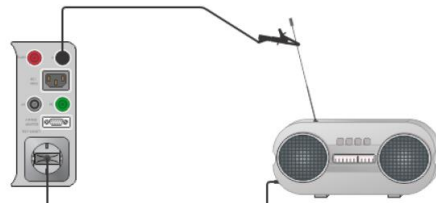
Test izolačného odporu pre spotrebič triedy II.
